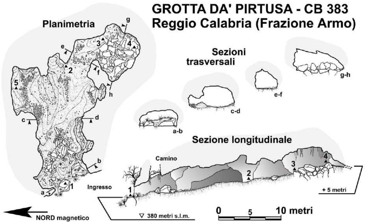
Fig. 2 - Topografia della Grotta da' Pirtusa, con vedute in planimetria, sezione longitudinale e sezione trasversale.
